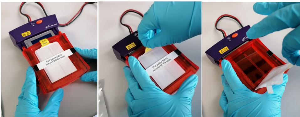
3. Preencha todos os poços de amostra com água destilada ou desionizada. Incline a cassete e com papel absorvente suave (lenço de papel) remova o excesso de água. Não seque os poços diretamente.
